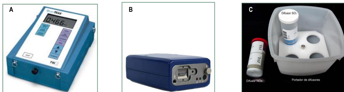
Figura 10. Monitores continuos en tiempo real (1 minuto), A: DustTrak (TSI) para monitoreo de MP_{2.5} . B: Microaethalometer (AethLabs) para monitoreo de BC. Monitoreo discreto de gases. C: Difusor de gases (IVL) para monitoreo discreto de SO_2 y NO_x .
