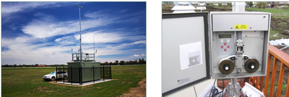
Figura 29. Implementación de una estación de monitoreo de contaminantes atmosféricos y meteorología (izquierda). Sensor continuo de MP_{2.5} en mediciones horarias (derecha).
